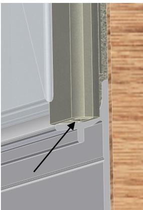
2. Koppelungsdichtung einseitig in Nut der Aluschale so einstecken dass diese am Fensterbankanschlussprofil aufsteht.
