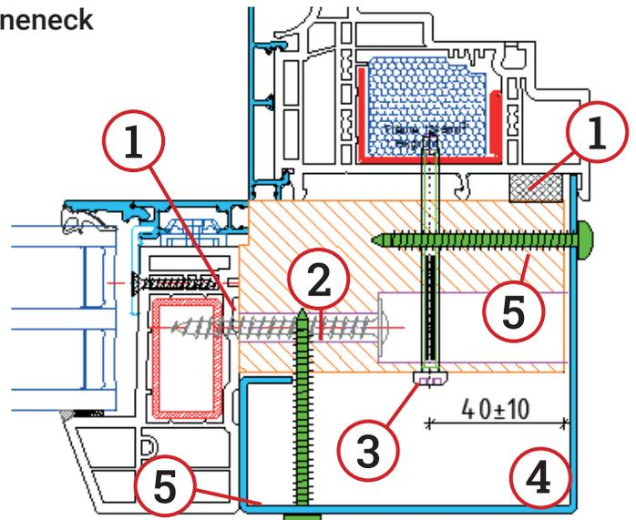
1. Über den gesamten Rahmenrücken Kleberaube ziehen Komriband auf Stockverbreiterung kleben
