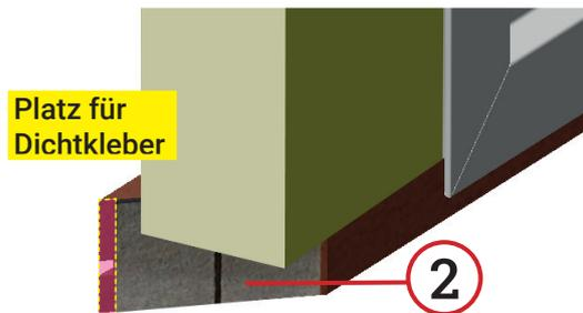
1. Komriband auf Gehung des TAPs kleben - von Außen muss noch Platz für Dichtkleber<sup>1</sup> sein
