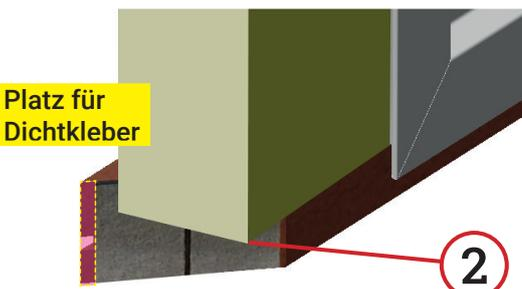
2. Komriband auf Gehrung des TAPs kleben - von Außen muss noch Platz für Dichtkleber<sup>1</sup> sein
