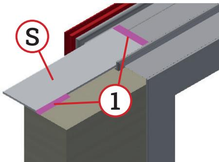
1. Übergänge von Kunststoffstreifen (S), wo Bänder geklebt werden, mit Dichtkleber auffüllen
